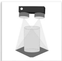
Nach vollständiger Trocknung von AESUB transparent kann das Objekt, wie gewohnt, gescannt werden.
