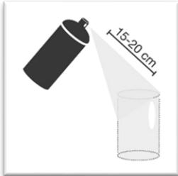
Tragen Sie AESUB transparent aus einem Abstand von 15-20 cm auf. Besprühen Sie die komplette Oberfläche, die gescannt werden soll. Betätigen Sie den Sprühkopf und bewegen Sie die Sprühdose gleichmäßig, mit der Düse auf das Objekt gerichtet, langsam hin und her, um eine gleichmäßige Beschichtung zu erhalten.
