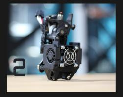
Druckkopf mit NanoXtruder und Phaetus Dragon UHF Hotend welches eine deutlich gesteigerte Durchflussleistung aufweißt und sehr gut geignet ist für Faserverstärkte Materialien
