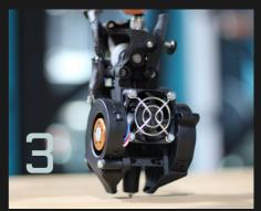
High Performance Druckkopf mit NanoXtruder und Goliath Hotend mit und einer extrem hohen Aufschmelzleistung und sehr starker Kühlung ermöglichen Düsengrößen bis hin zu 1,8mm
