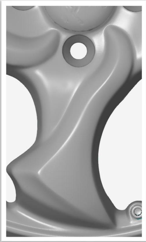
Verfahren Sie entsprechend mit allen weiteren Sektionen. Etwaige übersprühte Punkte der vorhergehenden Sektion müssen vom Spray befreit werden, um eine problemlose Verknüpfung der Sektionen zu erreichen.
