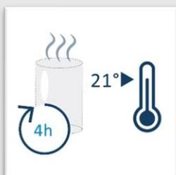
Die aufgetragene Schicht von AESUB blue verflüchtigt selbstständig nach dem Scannen. Die sonst aufwendige Reinigung nach der Anwendung entfällt.
