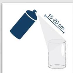
Tragen Sie AESUB blue aus einem Abstand von 15-20 cm auf. Besprühen Sie die komplette Oberfläche, die gescannt werden soll.
