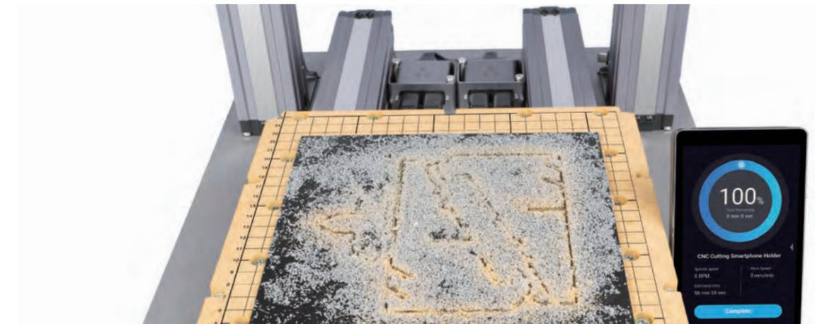
2. Reinigen Sie das fertige Werkstück und das Gerät mit einem Staubsauger und entfernen Sie dann das fertige Werkstück mit dem Seitenschneider.
