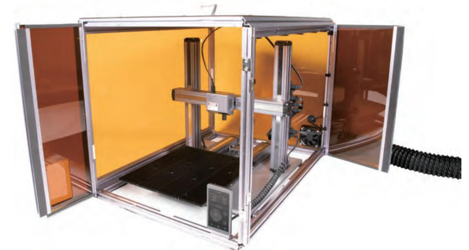
3. Schalten Sie das Gerät aus, trennen Sie das Kabel zum Werkzeugkopf und entfernen Sie dann den Werkzeugkopf und die Plattform.
