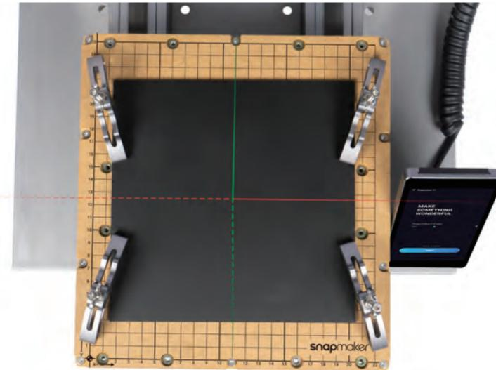
2. Befestigen Sie das Klemmenset an der CNC-Fräsplattform und fixieren Sie dann das Material anhand Verschrauben der Flügelmutter.
