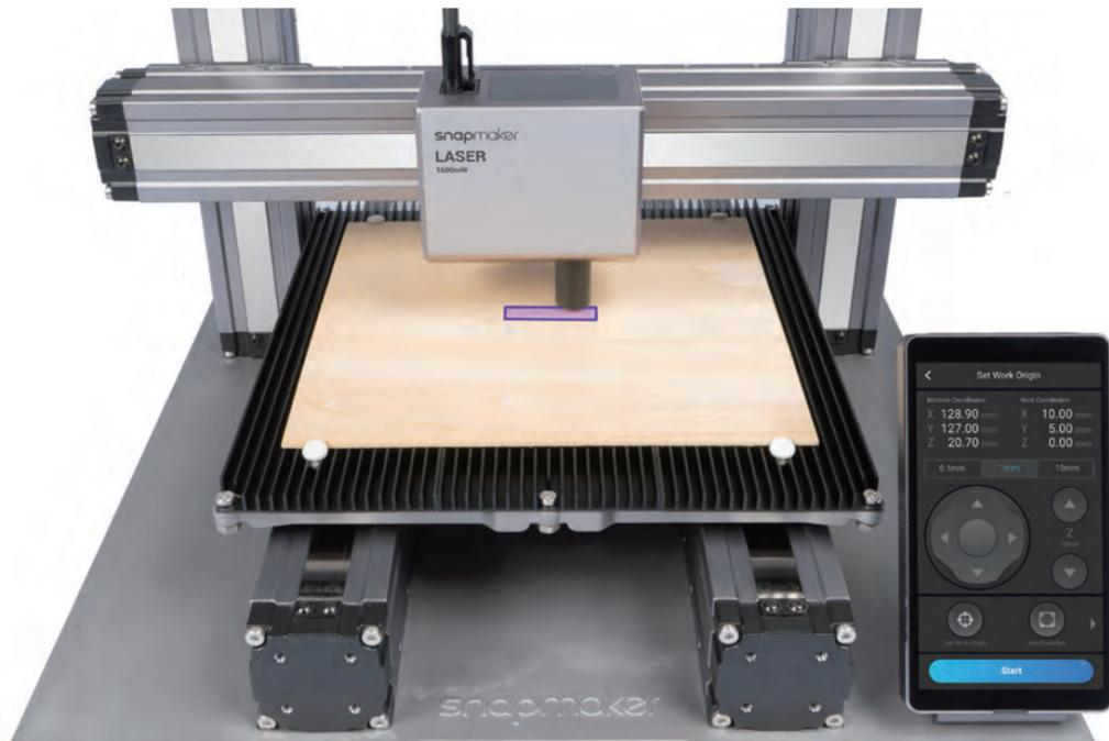
5. Tippen Sie auf **Start**, und das Gerät fokussiert automatisch.
