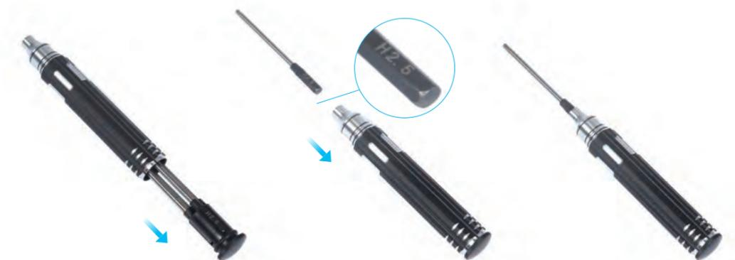
Zur Montage des Geräts wird der Schraubendreherkopf H 2,5 verwendet. Die anderen Köpfe werden für Wartungsarbeiten verwendet. Stellen Sie sicher, dass der Schraubendreherkopfhalter vor dem Gebrauch wieder in den Griff eingesetzt wurde.
