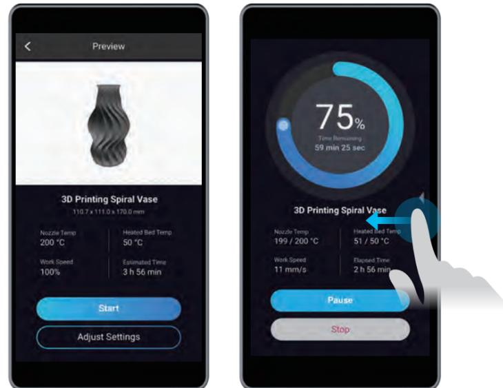
Im Falle einer schlechten Haftung, streichen Sie auf der Druck-Fortschrittsanzeige nach links und versuchen Sie den Z-Ausgleich einzustellen. Sie können auch versuchen, das beheizte Bett erneut zu nivellieren, indem Sie **Kalibrierung** auswählen. Stellen Sie sicher, dass die Düsen Spitze sauber ist, bevor Sie das Bett kalibrieren.
