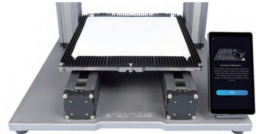
2. Tippen Sie auf **Start**, und das Gerät wird das eingravierte Quadrat zur Kalibrierung der Kamera verwenden.
