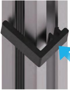
Kippen Sie die Einrastverbindung der Kabelklemme ein und drücken Sie sie gegen die Nut des Trägers, um sie einzurasten. Die Leiste der Kabelklemme sollte das Kabel in der angrenzenden Nut halten.
