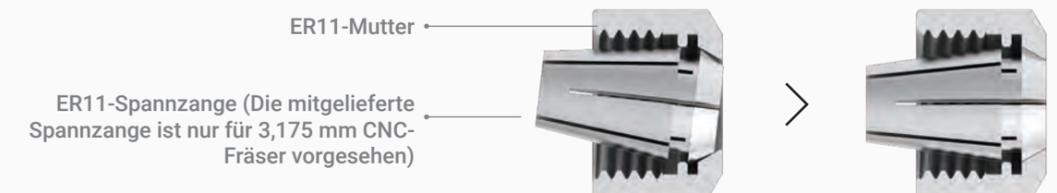
2. Setzen Sie die CNC-Schutzbrille auf. Setzen Sie den CNC-Fräser in die ER11-Spannzange ein (für unser bereitgestelltes Modell ist ein Flachfräser erforderlich). Drücken Sie den CNC-Fräser weiter, bis sein Anschlag die Hülse der ER11-Spannzange berührt.
