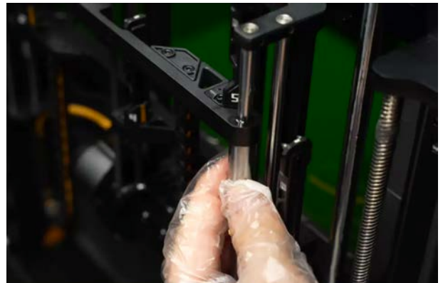
Schmieren Sie die Linearwellen
