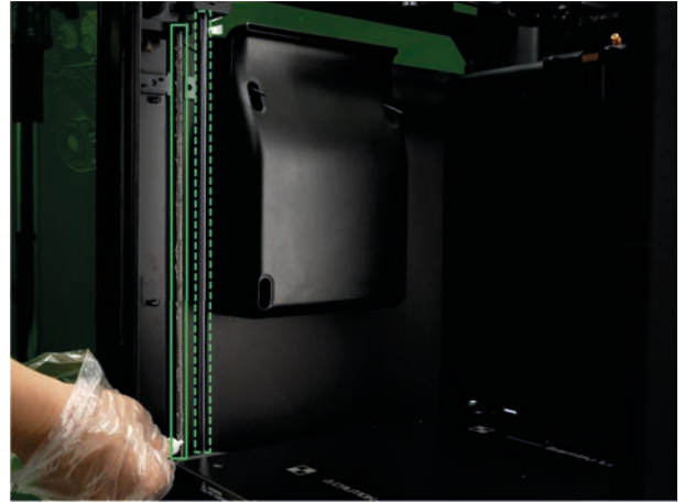
Schmieren Sie die Z-Achsen-Gewindespindeln und Linearwellen
