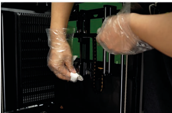
Wischen Sie das Induktions-Hotend-Magazin ab
