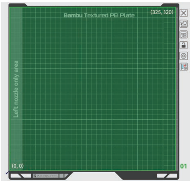
Bedruckbarer Bereich des linken Hotends
