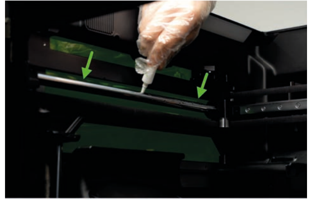
Schmieren Sie die linke Y-Achsen-Welle.
