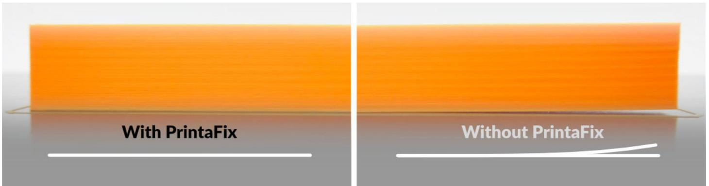
**PrintaFix ist die beste Lösung für FDM 3D Drucker, um das Problem des Warping und der zu geringen Haftung auf der Druckplatte zu eliminieren.**
