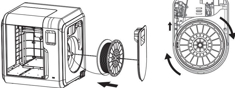
Beachten Sie die Laderichtung des Fadens. Er muss, wie in der Abbildung, im Uhrzeigersinn geladen werden.
