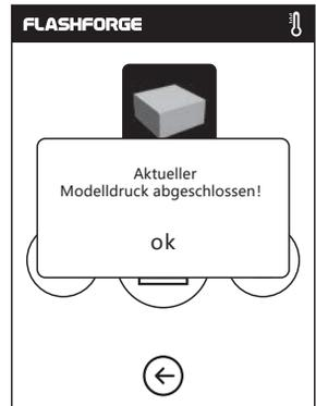
3. Der Extruder erwärmt sich und sobald der Aufwärmvorgang abgeschlossen ist, beginnt der Druckvorgang. Nach dem Abschluss des Modelldrucks, gibt der Drucker einen Piepton aus und am Touchscreen wird eine Meldung angezeigt.
