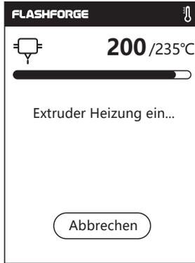
1. Berühren Sie [Strang] --Berühren Sie [Auswurf]. Der Extruder wird vorgewärmt.
