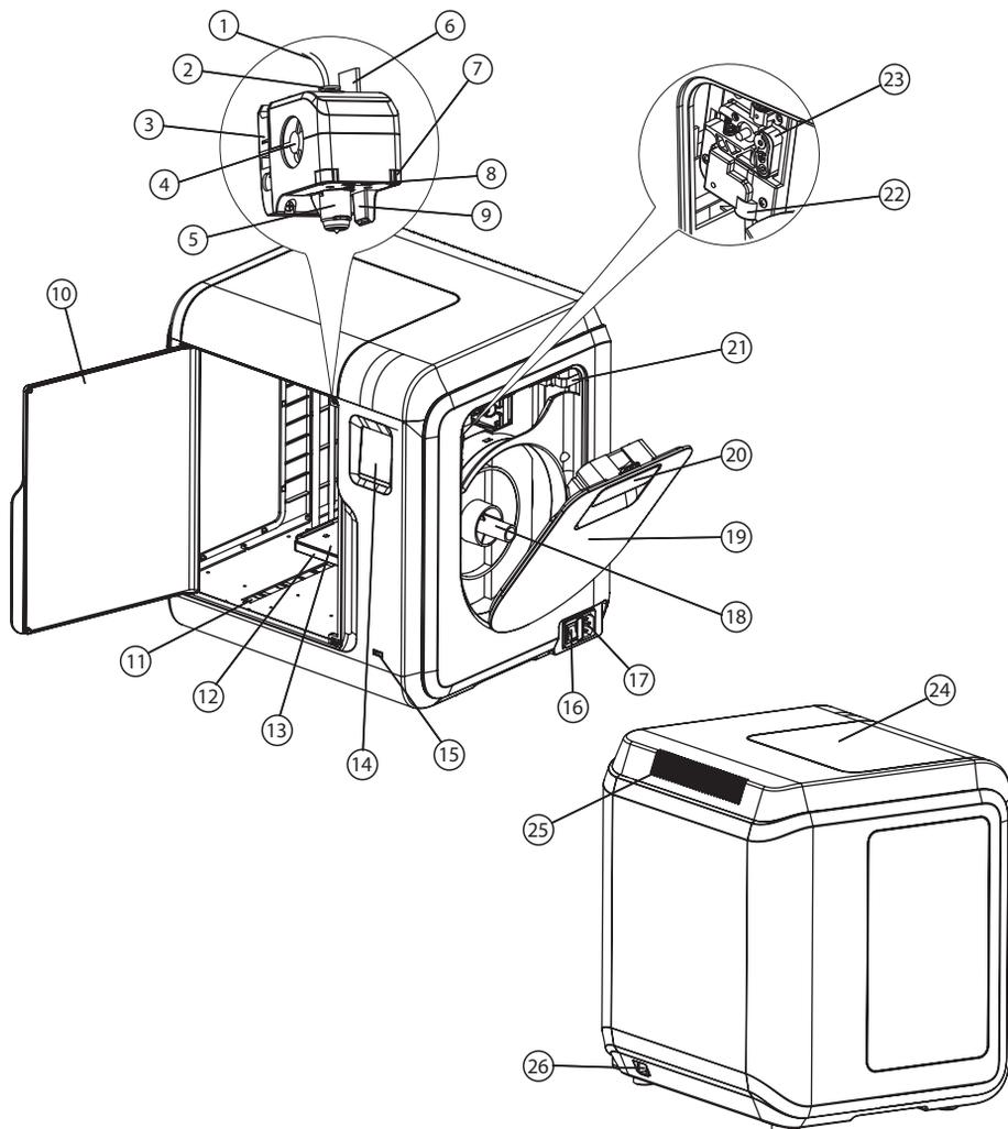
1. Fadenführungsrohr 2. Fadenführungsrohrverbindung 3. Extrudersockel 4. Kühlgebläse
