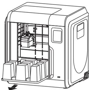
7. Öffnen Sie die Vordertür, nehmen Sie den Karton aus dem Drucker und packen Sie ihn vollständig aus.
