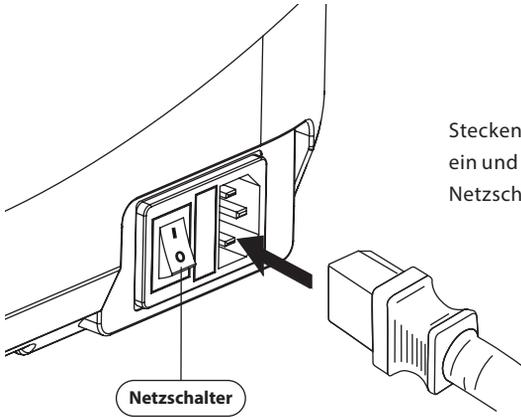
Stecken Sie das Stromkabel an der Rückseite ein und schalten Sie den Drucker mit dem Netzschalter ein. Der Touchscreen wird eingeschaltet.
