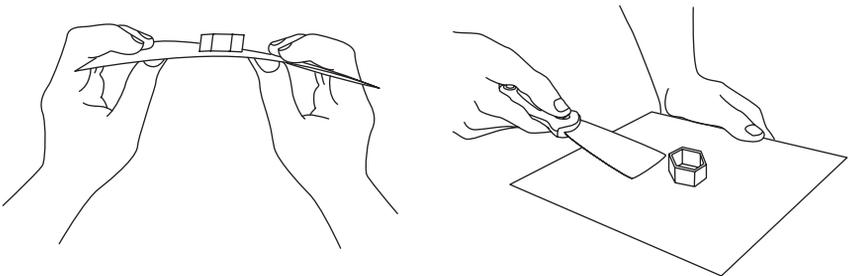
2. Biegen Sie die Konstruktionsplattform. Die Plattform wird sich leicht verformen. Trennen Sie die Plattform vom Boden des Modells (lösen Sie ein Modell, egal ob klein oder groß, bitte mithilfe eines Spachtels).
