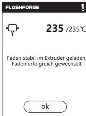
3. Das Laden ist abgeschlossen, sobald der Faden aus dem Extruder austritt. Berühren Sie [OK]. Setzen Sie die Fadenspule in den Spulenhalter ein. Schließen Sie die Fadenabdeckung.
