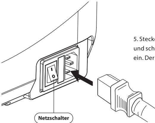
5. Stecken Sie das Stromkabel an der Rückseite ein und schalten Sie den Drucker mit dem Netzschalter ein. Der Touchscreen wird eingeschaltet.
