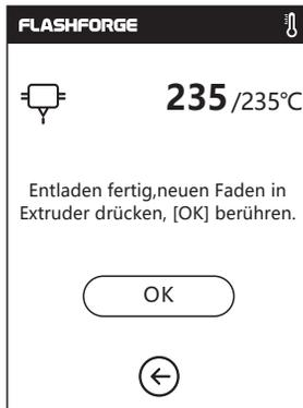
4. Sobald der neue Faden stabil aus dem Extruder austritt, ist der Wechsel abgeschlossen. Berühren Sie [OK].
